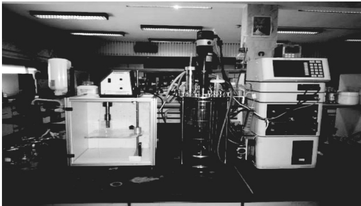
Fig. 1(a). Aerobic/Anoxic test using New Brunswick Fermentor.
