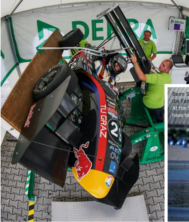
Die Dichtigkeit und Überrollfähigkeit der Rennwagen werden am Tilt-Table simuliert. The leak tightness and roll-over potential of the vehicles are tested using a tilting platform.
