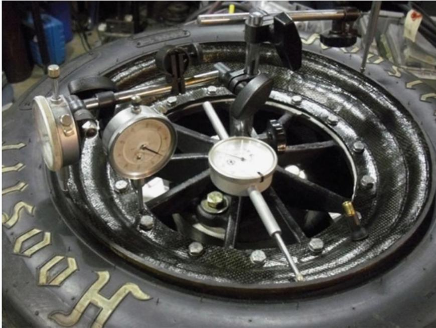
5 Mit Messuhren wurde die Biegung gemessen, während das Rad auf einem statischen Prüfstand seitlich belastet wurde
