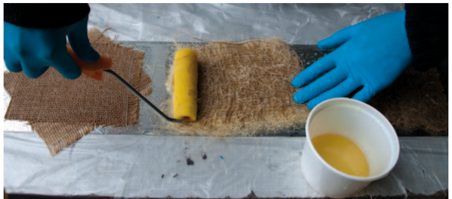
2 Laminierproben mit verschiedenen Naturfasern Laminating tests with various natural fibers
