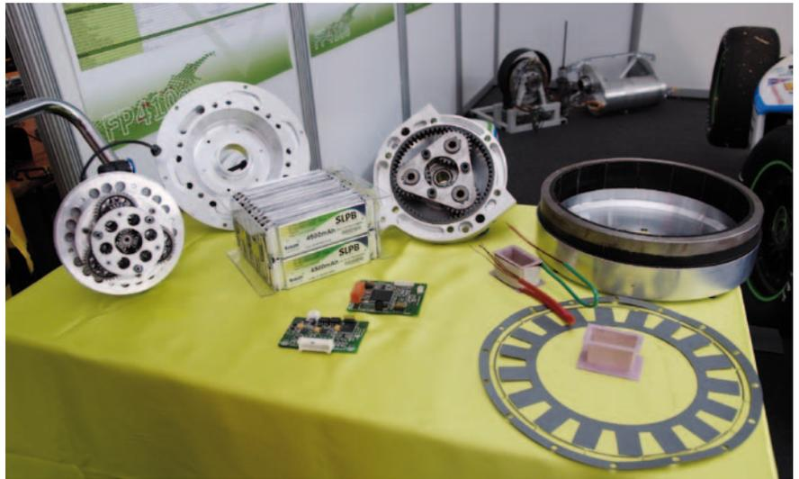
1 Einige Teams entwickeln zahlreiche Komponenten des HV-Systems und Antriebsstrangs selbst: Getriebe, Akkupack, Elektronik und Motorkomponenten des WHZ Racing Teams aus Zwickau
