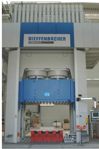
Bild 2: LFI-Anlage mit Werkzeugformenträger (links), 3000-t-Multifunktions-Schnellhubpresse (Mitte) und Hochgeschwindigkeits-Radialflechtanlage (rechts)
