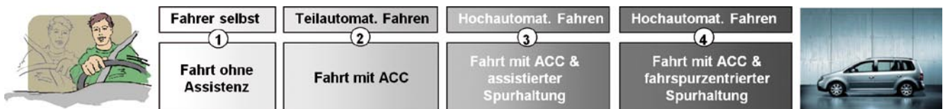
Bild 2: Integrierte vier Automationsstufen
