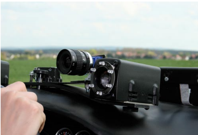
Mit Kameras wird die Fahrerreaktion beobachtet
