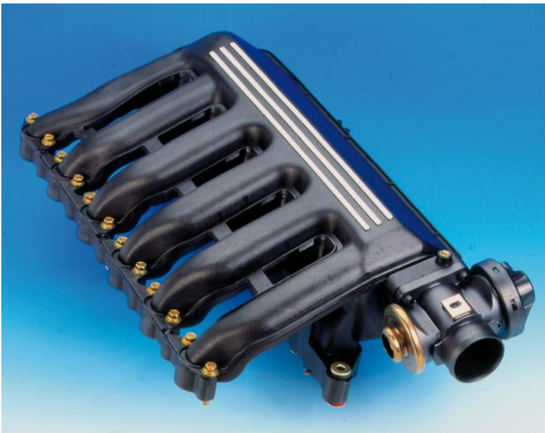
Bild 8: Kunststoffsauganlage des BMW-Sechszylinder-Dieselmotors
