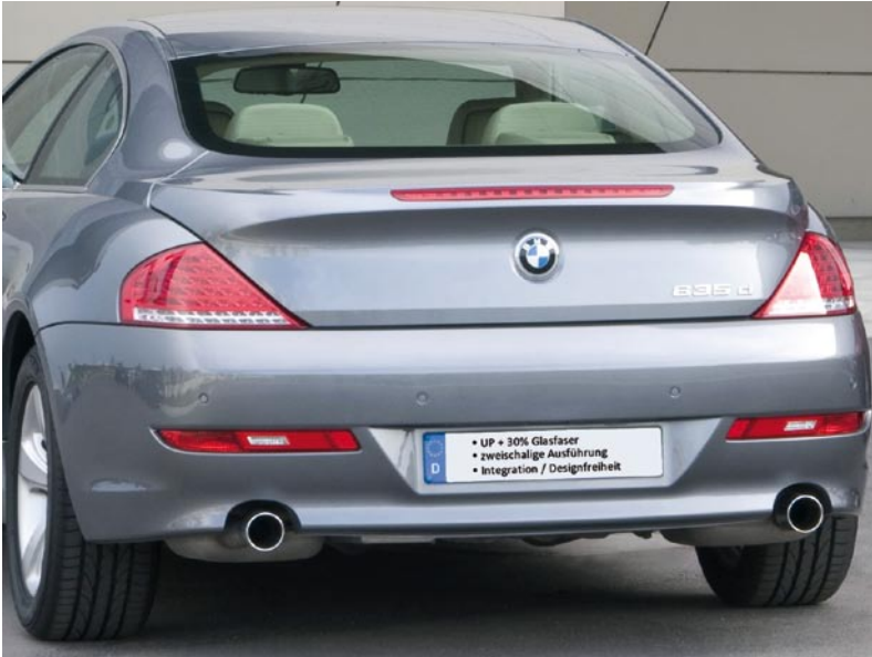
Bild 4: Heckklappe aus SMC in der BMW-6er-Reihe
