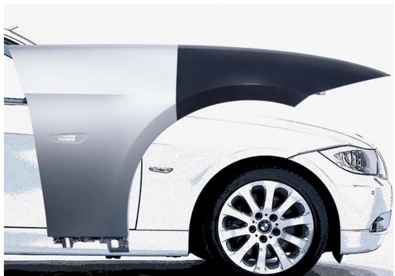
Bild 3: Vordere Seitenwand aus Thermoplast beim BMW 3er Coupé/Cabriolet
