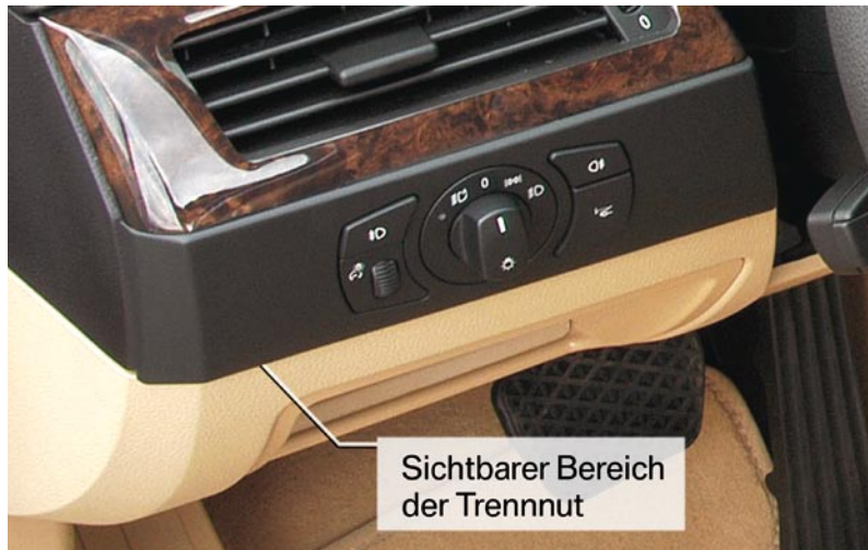
Bild 9: Sichtbare Trennnut an der Instrumententafel des BMW 5er
