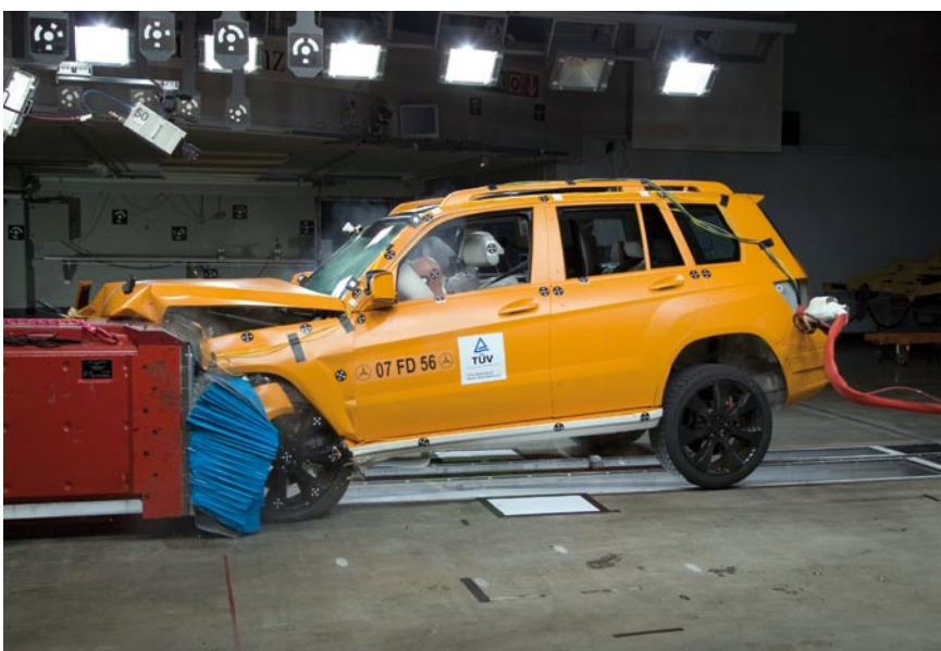
Bild 2: Bestmöglicher Insassenschutz beim Frontalaufprall (Crashtest, Kraftpfade, Simulation) durch effektiv wirkende Kräfteinleitungspfade und die hochstabile Fahrgastzelle
