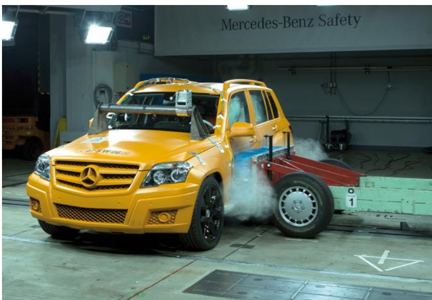
Bild 4: Beim Seitenaufprall (Crashtest, Kraftpfade, Simulation) schützen eine hohe Quersteifigkeit und zusätzliche Tunnelstreben, die Energie an die crashabgewandte Fahrzeugseite leiten, die Insassen
