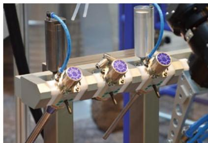
1-Apparat kann aus Kleinmengenbehältern, die direkt am Apparat angebracht sind, aus extern platzierten Druckbehältern oder mit Pumpen aus dem Programm des Herstellers versorgt werden.
