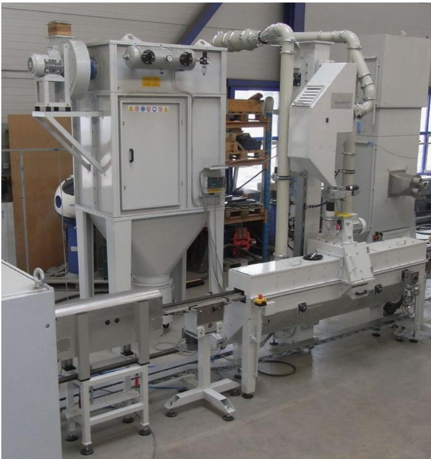
Beispielanwendung der neu entwickelten Schleuderrad-Generation in einer Bremsträgerstrahlanlage des Systemlieferanten Waldruff Technologies
