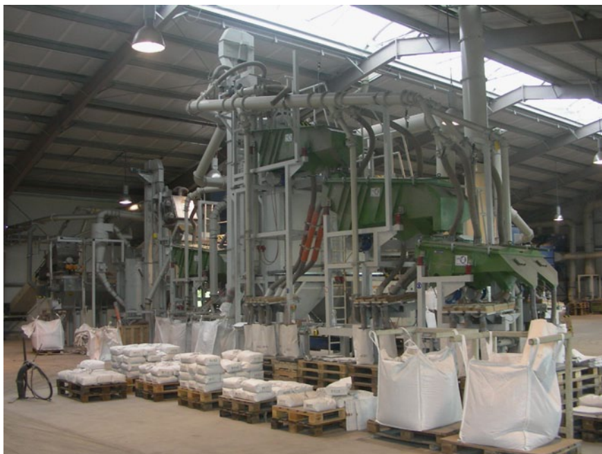
Die Strahlmittelabfälle werden im Recyclingwerk in den unterschiedlichen Aufbereitungsschritten getrocknet, gesichtet, enteisen, ausgesiebt und abschließend in Säcke oder Big Bags für den Wiederverkauf verpackt
