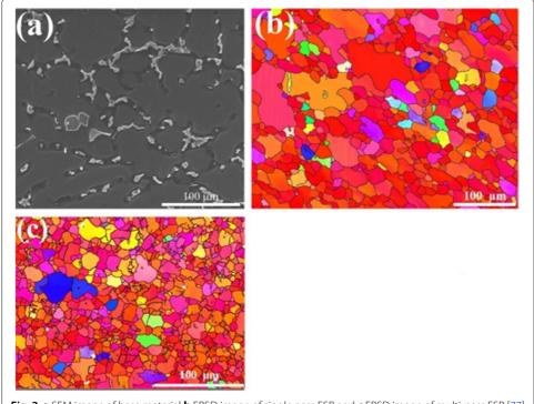
$\textbf{Fig. 2 a} \ \textbf{SEM} \ \textbf{image} \ \textbf{of} \ \textbf{base} \ \textbf{material} \ \textbf{b} \ \textbf{EBSD} \ \textbf{image} \ \textbf{of} \ \textbf{single} \ \textbf{pass} \ \textbf{FSP} \ \textbf{and} \ \textbf{c} \ \textbf{EBSD} \ \textbf{image} \ \textbf{of} \ \textbf{multi-pass} \ \textbf{FSP} \ \textbf{[77]}$
