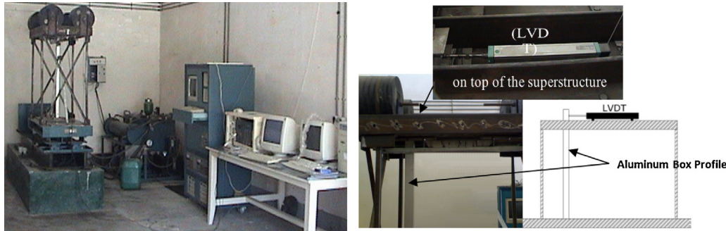
Fig. 8 – Shaking table unit.
