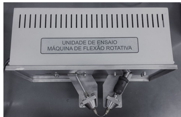
Fig. 1 Rotating-bending fatigue test apparatus
