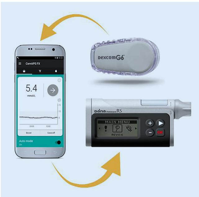
**Abb. 1** ▲ CamAPS FX App auf Android Handy, Dexcom G6 Sensor und Dana RS Insulinpumpe. (© Julia Ware. Diese Abbildung wurde mit [biorender.com](http://biorender.com) erstellt)
