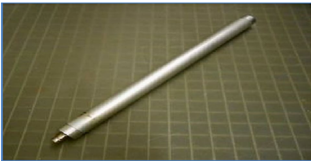
Fig. 9 Photo CP: LND 252 ( ^3\text{He} )-PC
