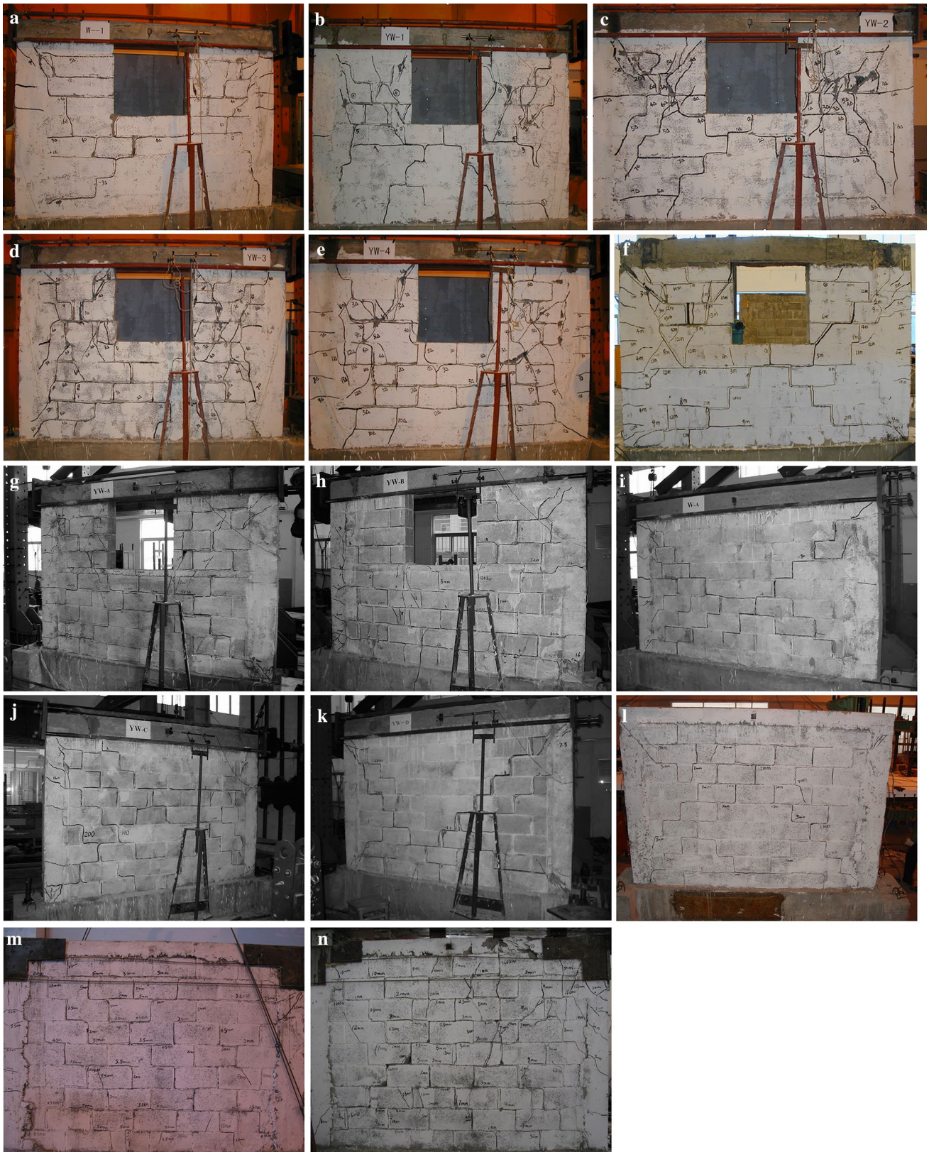
Fig. 4 Failure patterns of the specimens a W-1; b Yw-1; c Yw-2; d Yw-3; e Yw-4; f Yw-5; g Yw-a; h Yw-b; i W-a; j Yw-c; k Yw-d; l Dw-1; m DYw-1; n DYw-2
