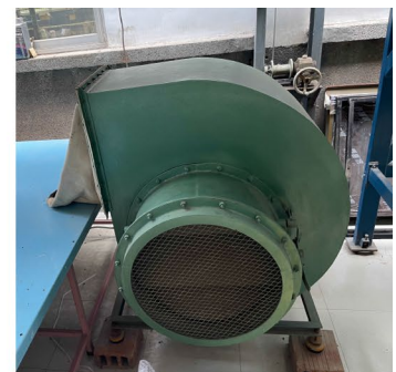
c. Centrifugal fan
