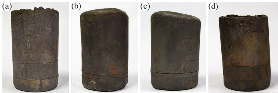
Figure 2. Tested steel ingots: (a) 0 wt.% Mg; (b) 0.0007 wt.% Mg; (c) 0.0014 wt.% Mg; (d) 0.0023 wt.% Mg.
