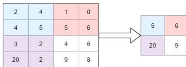
Fig. 2 The pooling layer
