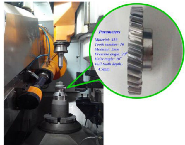
Fig. 4 S148-1331 gear and parameters
