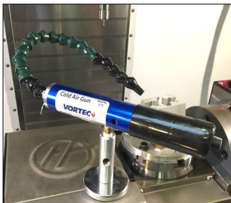
Fig. 6 A VORTEC adjustable cold air gun
