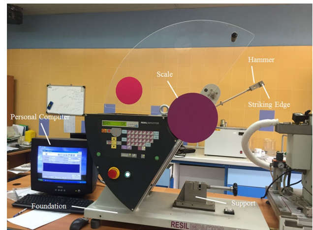
Fig. 22 Izod impact test machine
