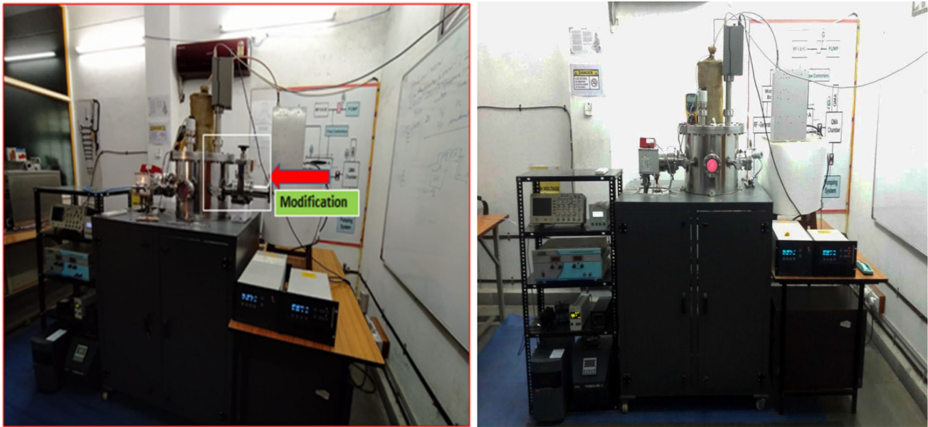
Fig. 1 Actual system for Producing Glow Discharge Plasma
