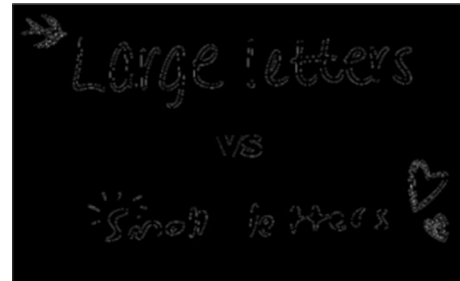
Fig. 10 Edge detection using canny Edge detector
