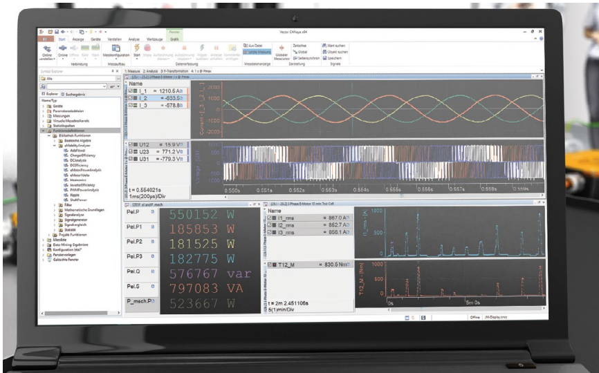
BILD 4 Leistungsanalyse während eines zehnmütigen Testlaufs am Prüfstand mit Vector Canape (© CSM)
