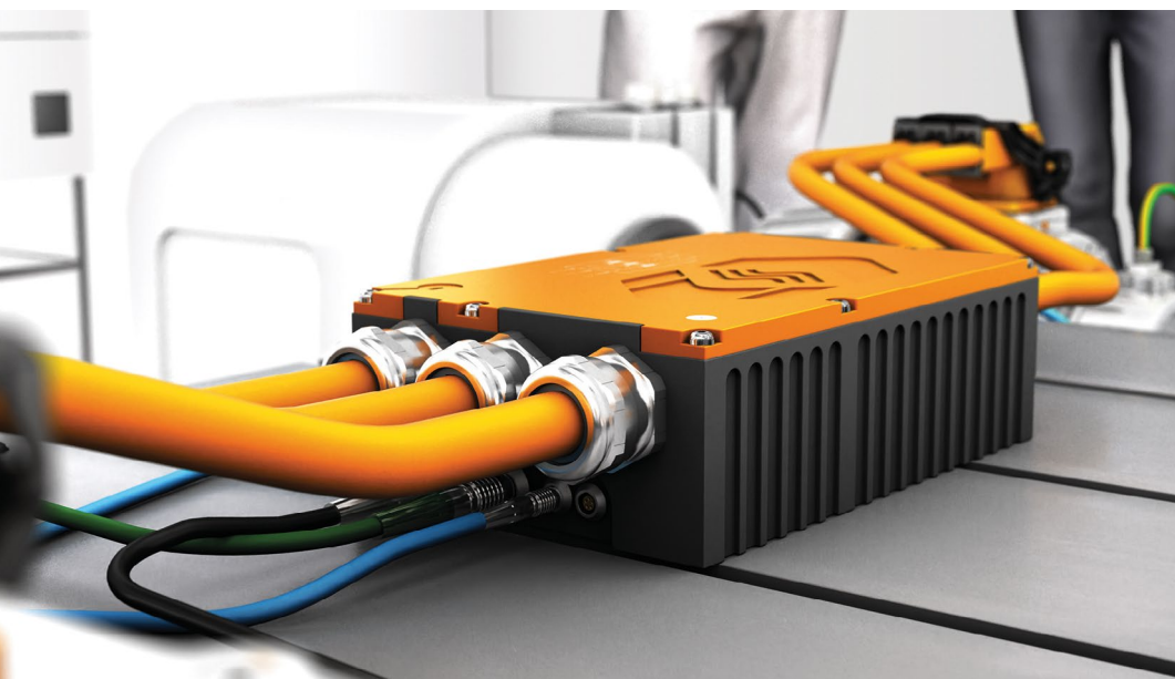
BILD 6 HV-Breakout-Modul 3.3.: Über Ethercat- und CAN-Schnittstellen kann das Messsystem mit weiteren Messmodulen erweitert werden. Über eine Gbit-Ethernet-Schnittstelle werden die Daten an den Messrechner gesendet. Über die PG-Verschraubungen werden HV-Leitungen bis 95 mm 2 innerhalb des Gehäuses angeschlossen (© CSM)
