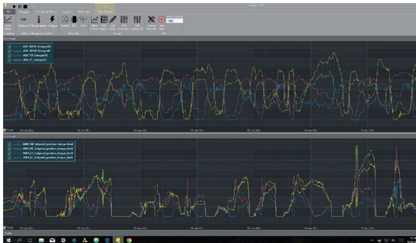
BILD 3 Dämpferposition und Drehmomentausgänge als Zeitfunktion (Simulation in Revolve Analyze) (© Revolve NTNU)
