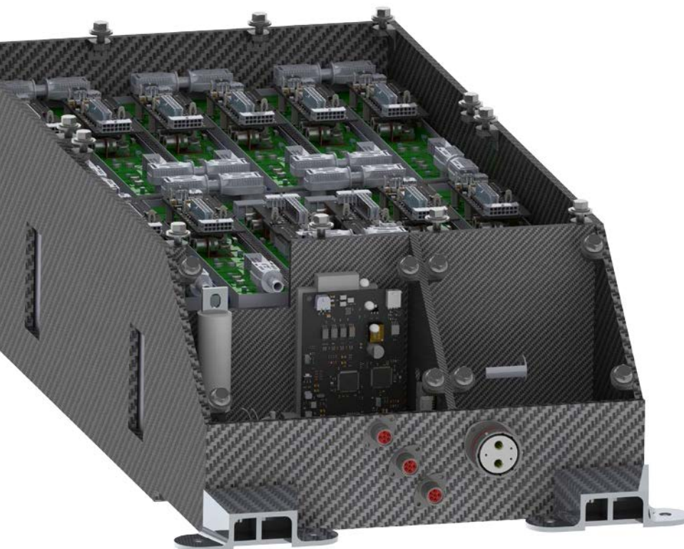
BILD 2 Akkumulator mit 12 verteilten Überwachungskarten (© Revolve NTNU)
