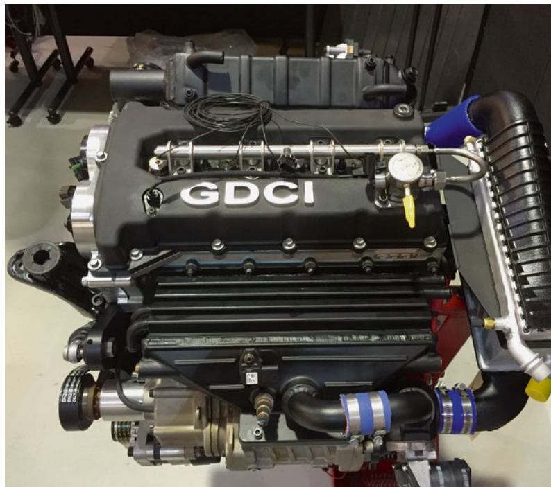
Das neue Hochdruck-Einspritzsystem operiert mit bis zu 350 bar Einspritzdruck und kann auf bis zu 400 bar ausgelegt werden
