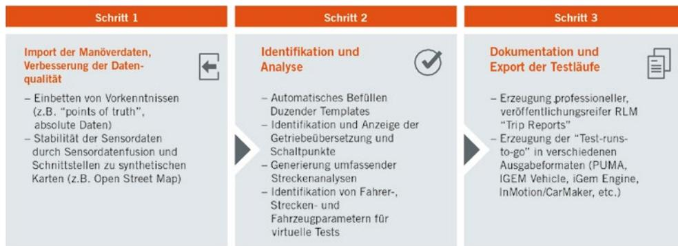
**BILD 5** Transformation der realen RDE-Versuche in virtuelle Fahrversuche (© AVL)
