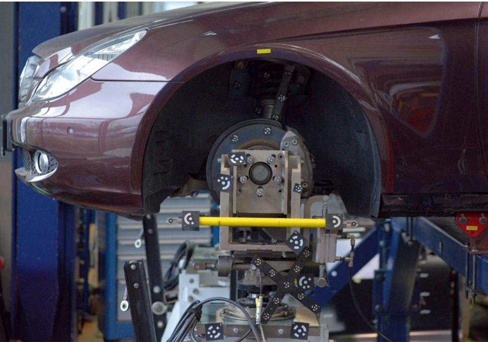
**BILD 1** Messaufbau zur Bestimmung der Geometriedaten an der Vorderachse (© fka)
