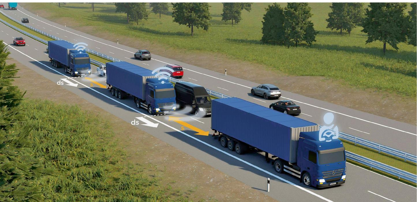
**BILD 1** Platooning-Fahrzeuge in der Simulationsumgebung TruckMaker (© IPG Automotive)
