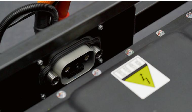
**BILD 4** Fahrzeugbasierter Schnellverschlussstecker für die Hoch- und Niederspannungsverbindung zwischen Batterie und Fahrzeug (© GETEC Getriebe Technik GmbH)
