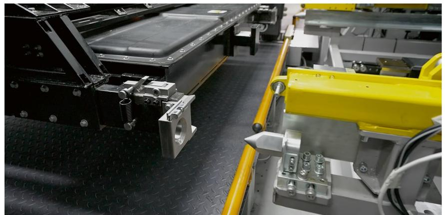
**BILD 2** Fahrzeug- und stationsseitige mechanische Ausführung des einseitigen Batteriewechsels (© GETEC Getriebe Technik GmbH)
