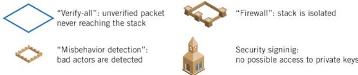
**BILD 2** Autotalks setzt den Empfehlungen von NPRM folgend auf mehrschichtige Sicherheit, um mehrfache Gefahren besser abzuwehren; das Sicherheitsschema kann analog zu einem Schloss aufgebaut sein; ein einfacher Sicherheitsmechanismus ist nicht ausreichend (© Autotalks)
