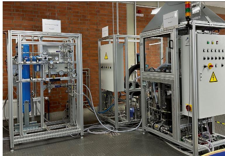
**BILD 1** Prüfstand des THWS für BZ-Stacks mit 30 kW (© THWS)
