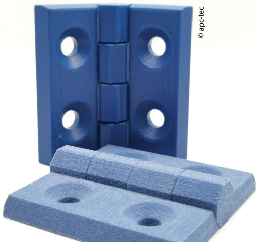
Gravierender Unterschied, auch in der Farbintensität: Ein 3D-gedrucktes Bauteil aus PA11 Blue im unbehandelten (vorne) und geglätteten Zustand (hinten).
