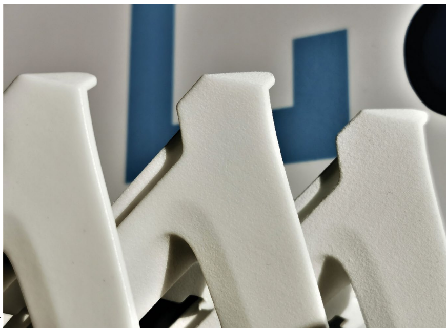
Additiv gefertigtes Bauteil – rechts im Rohzustand, in der Mitte mechanisch geglättet und links chemisch geglättet.
