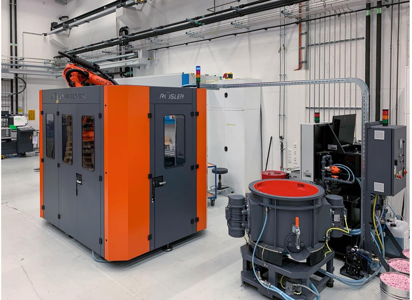
Zur praxisnahen Forschung für wissensbasierte Gleitschliffprozesse wurden zwei neue Bearbeitungsanlagen sowie eine halbautomatische Zentrifuge für die Prozesswasseraufbereitung angeschafft.
