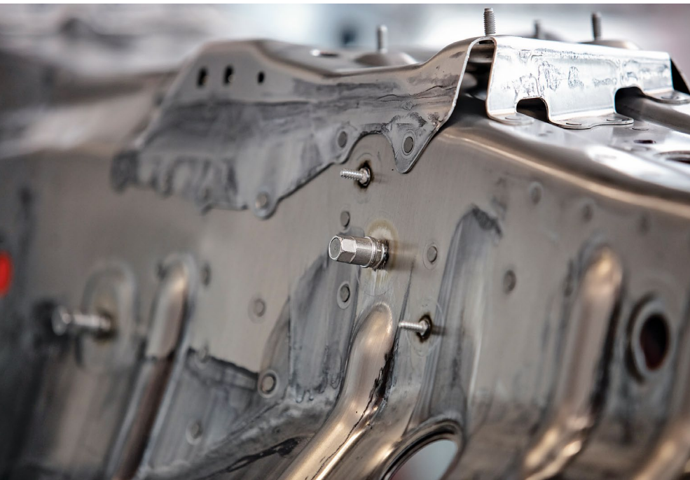
Geschweißter Massebolzen des Tunnelbauteils des Audi A8.
