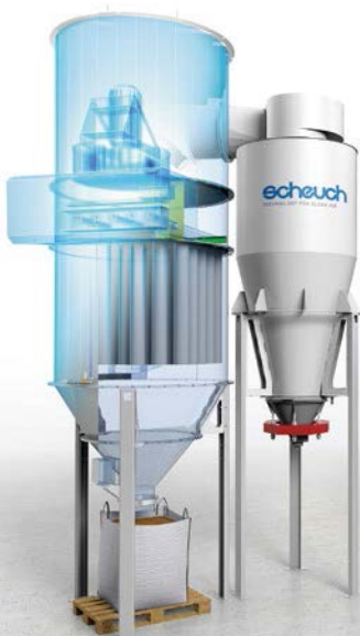
Durch die runde Ausführung des Filters werden die Patronen annähernd gleich stark belastet.
