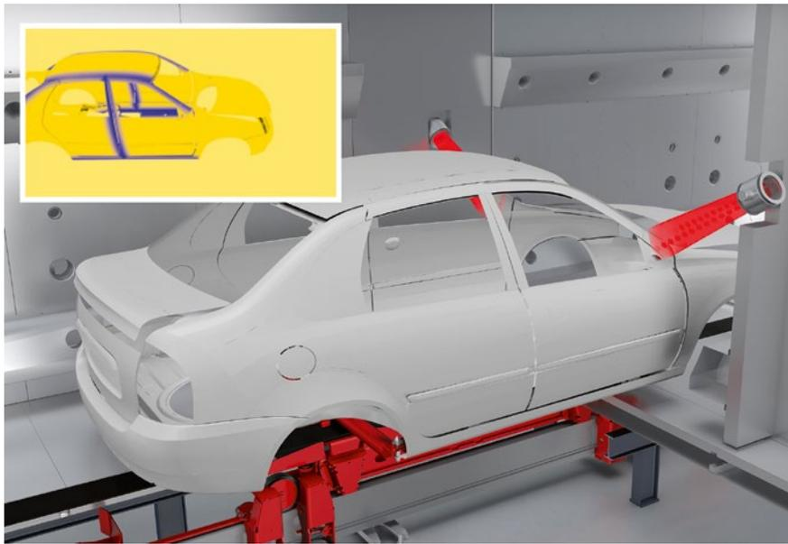
Temperatur und Luftströme lassen sich durch Schwenkdüsen optimal an verschiedene Karosserietypen und -bereiche anpassen. Dies stellt die bedarfsgerechte Aufheizung entsprechend der jeweiligen Materialstärke sicher.
