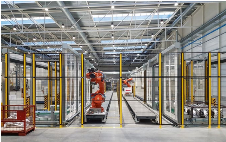
Die 35 Meter lange Anlage zum Schleifen von Alu-Strukturbauteilen ist bei einem Druckgusslieferanten in der Slowakei erfolgreich im Einsatz.
