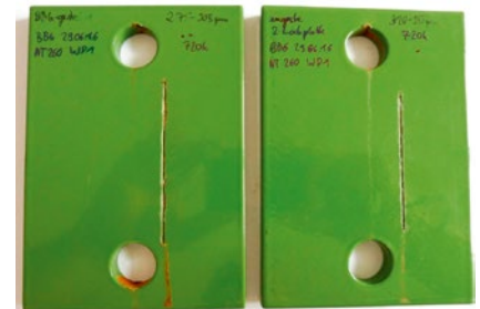
Produktionsteile nach 720 h NSS (von links nach rechts: stark verzundertes Teil, Guss, dickwandiges Teil gestrahlt, dickwandiges Teil ungestrahlt).
