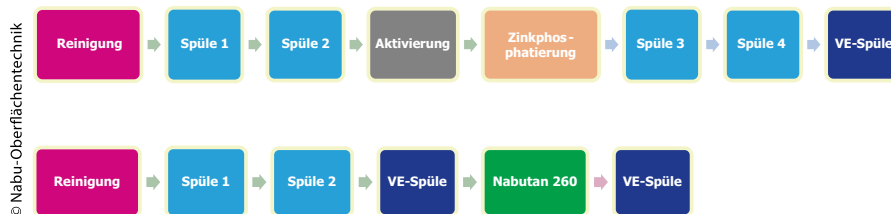
Oben: Prozessablauf Zinkphosphatierung, unten: Prozessablauf der Stahlpassivierung.
