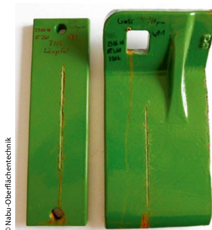
Produktionsteile nach 720 h NSS (von links nach rechts: stark verzundertes Teil, Guss, dickwandiges Teil gestrahlt, dickwandiges Teil ungestrahlt).
