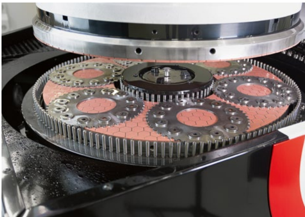
Das Feinschleifen kann bei Bauteilen aus einer Vielzahl von Werkstoffen zum Einsatz kommen und erlaubt präzise Planparallelität von Oberflächen.
