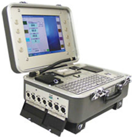
Fig. 2 TVC data logger (arc logger-ALXII)
