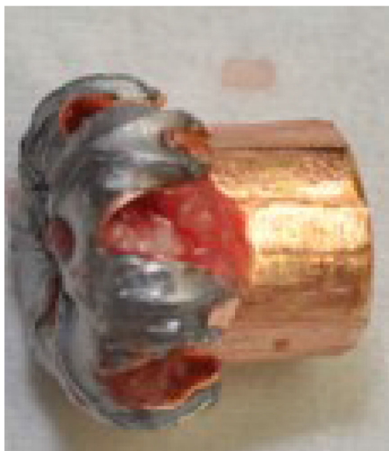
Fig. 1 Champiognage d'un projectile COP
