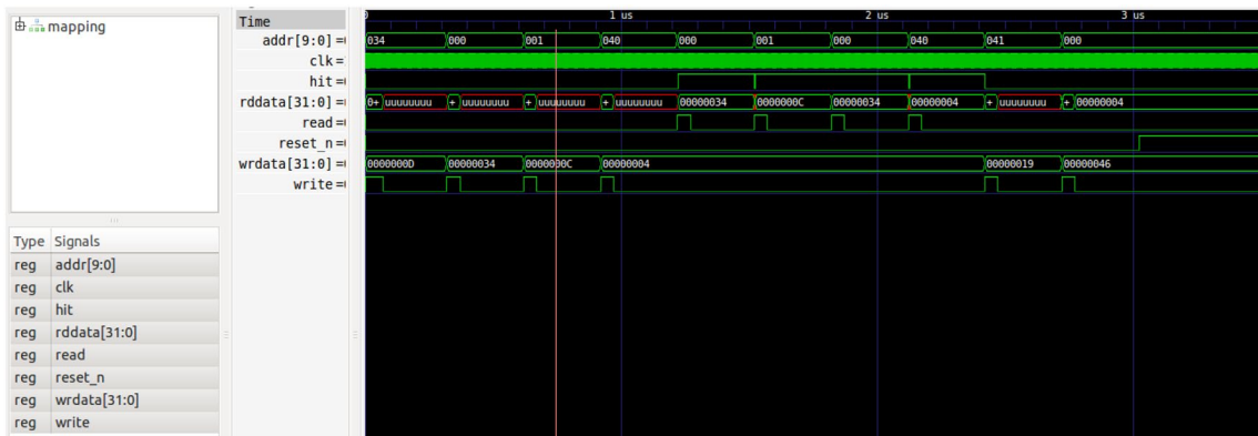
Fig. 16 Simulation results of RAM—cache
