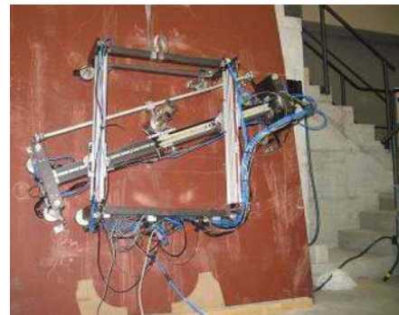
Fig. 11 Grit blasting robot 86
