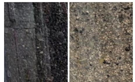
▲ Abb. 1: Pelletierte Biomasse ohne (links) und mit mineralischen Ausfällungen (rechts).
